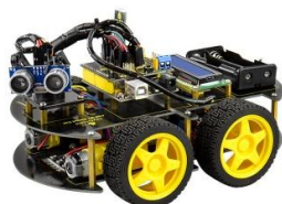
Рисунок 3.2. Мобильный робот с установленной мультисенсорной системой.
